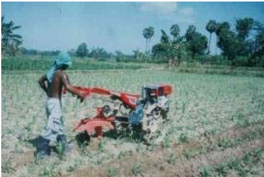
Mesin pembuat alur/drainase, pembumbun, dan penyiang.
