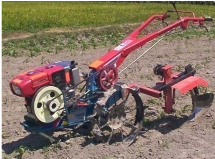
Alat mesin pembuat alur juga dapat dimanfaatkan untuk penyiangan gulma.
