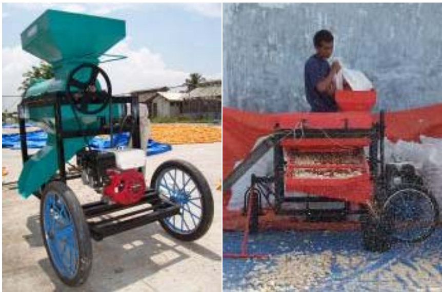
Alat-mesin pemipil jagung rakitan Balitsereal, kapasitas 5.000 kg/jam.
